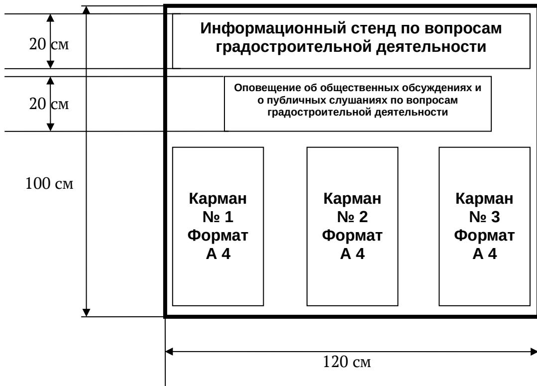
Информационный стенд - это отдельно стоящая плоская конструкция (вариант № 1), щит (вариант № 2), предназначенный для размещения информационных печатных материалов формата А4.
