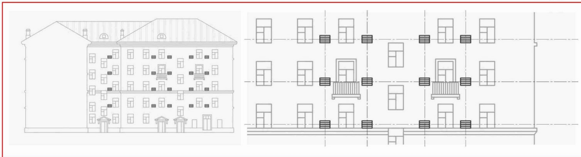
Пример правильного размещения кондиционеров на внутривором фасаде
