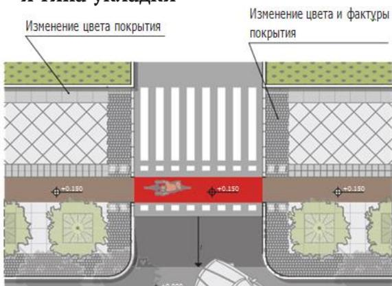
**Схема 3. Наземный пешеходный переход. Ширина пешеходного тротуара — более 3,0 м. Размещение тактильных указателей**
